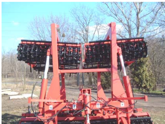
7.2. ábra: Hidraulikusan kiemelt géprészek mechanikus rögzítése
