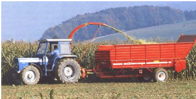
7.9. ábra: Szecskázott anyag szállítására alkalmas speciális pótkocsi
