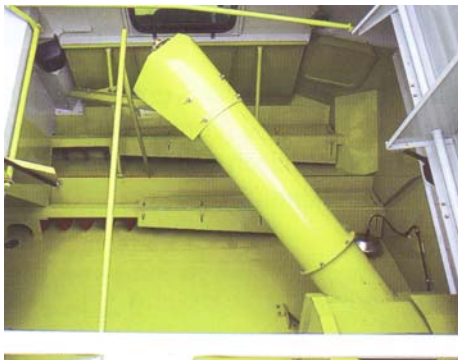
7.7. ábra: A magtartály kihordócsigája balesetet okozhat
