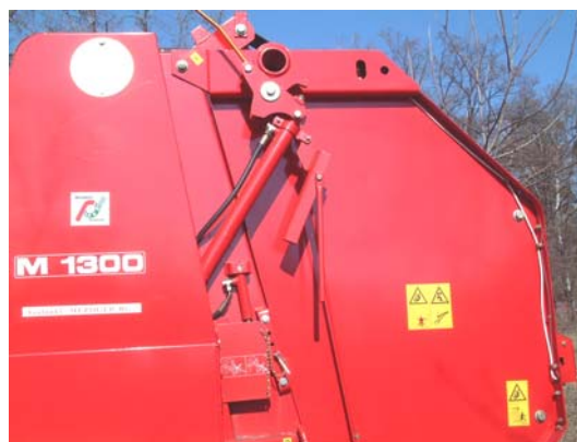
7.5. ábra: A munkahenger mechanikus kitámasztása
