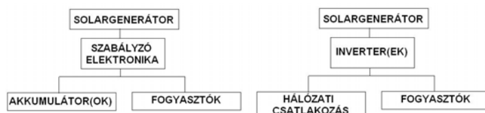
6.4. ábra: A szigetüzem és a hálózatra kapcsolt üzem elvi vázlata
