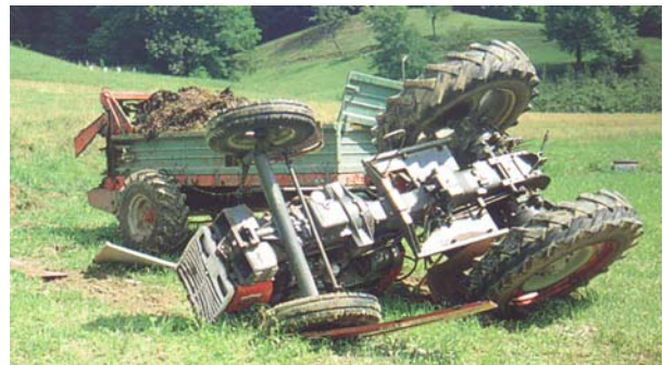
7.1. ábra: A hibás biztonsági berendezés boruláshoz vezethet
