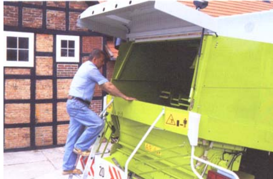
7.6. ábra: Az arató-cséplőgép szalmarázó-rostaegységének nyitható ajtói
