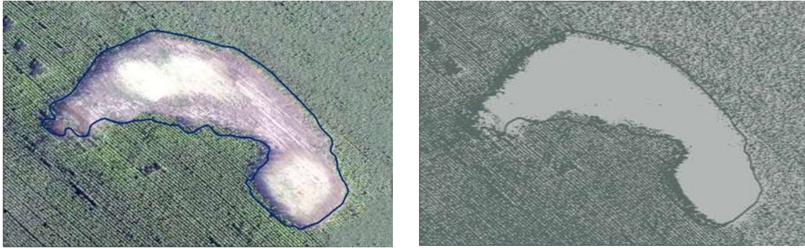
4. ábra: Fuzzy C-means klaszterezési eljárás bemutatása (Forrás: saját szerkesztés)
