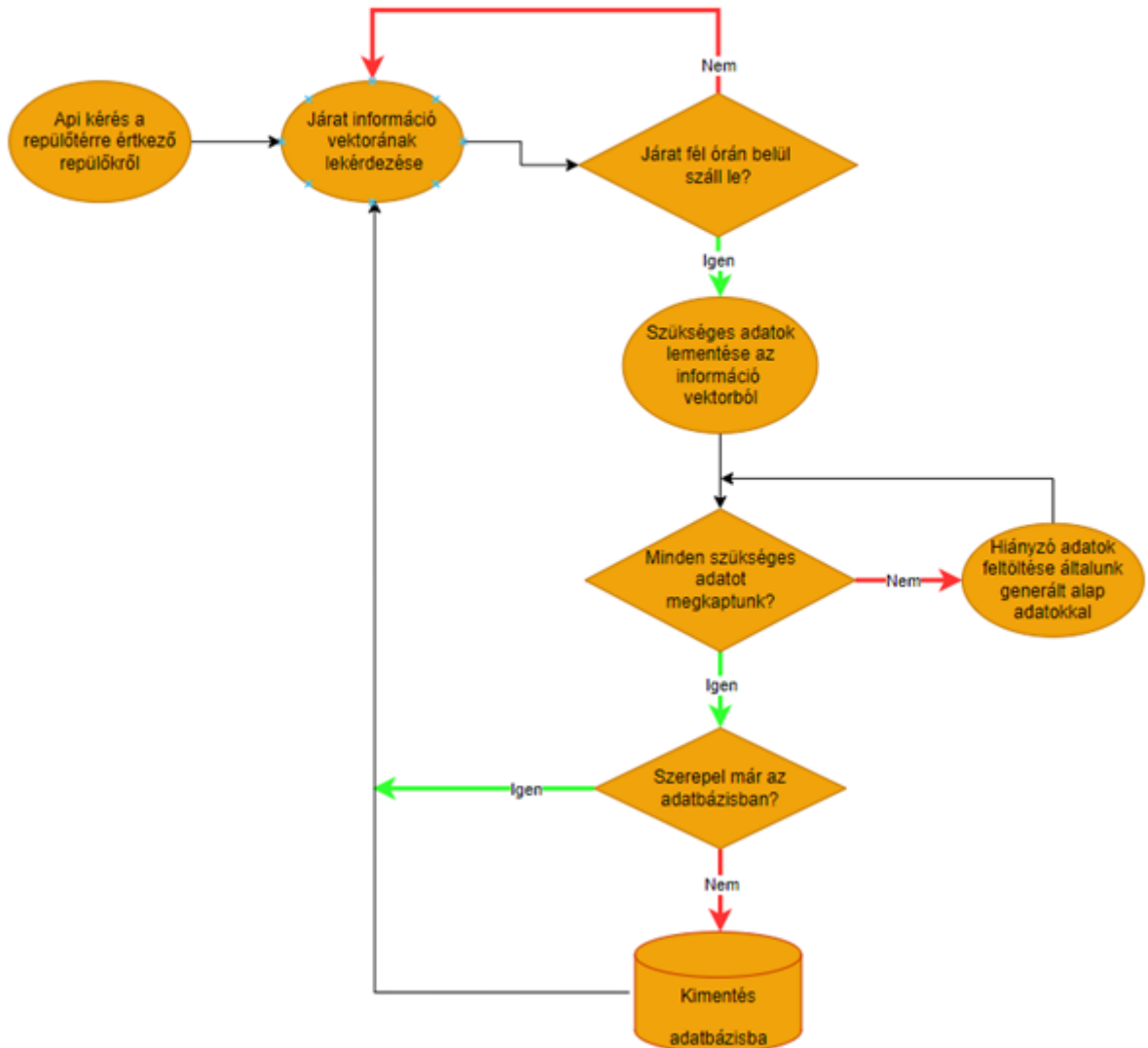
3.Ábra: Járatok ellenőrzése és mentése adatbázisba. (Saját ábra, Jelmagyarázat: Piros vonal: Elágazásban lévő feltétel nem teljesült, Zöld vonal: Elágazásban szereplő feltétel teljesült, Fekete vonal: Feltétel nélkül teljesülő lépések)
