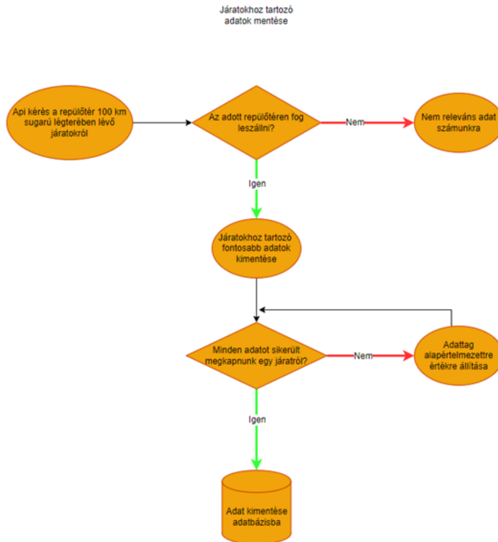
4.Ábra: repülőgépek pillanatnyi adatainak lekérdezése és eltárolása az adatbázisban. (Saját ábra, Jelmagyarázat: Piros vonal: Elágazásban lévő feltétel nem teljesült, Zöld vonal: Elágazásban szereplő feltétel teljesült, Fekete vonal: Feltétel nélkül teljesülő lépések)
