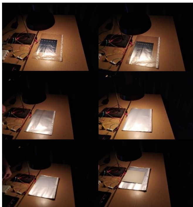
3.20. ábra: a mérőállás a 10. mérés során. A napelem felületén különböző mennyiségű réteg található (balról jobbra, majd fentről lefelé haladva: a bal felső képen 1, majd 3, 10, 25, 50 réteg, a jobb alsó képen pedig az 50 réteg felett még egy kartonból kivágott négyszög). (forrás: saját ábrázolás fotó: Pitlik Dóra)
